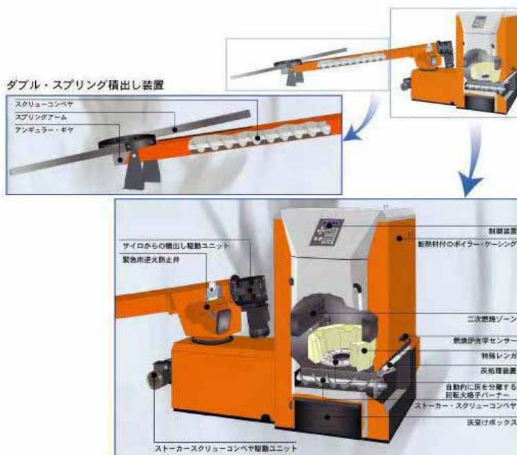
写真 5-1 シュミット製ペレットボイラー外観
